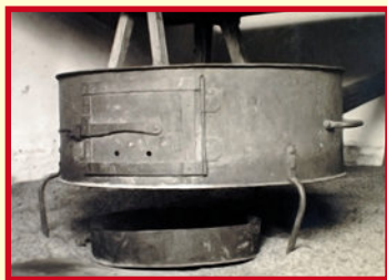
Kanonenofen - Früher benutzte man Kanonenöfen im Trocknungsraum
