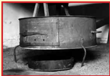
Four de séchage tambour. Jadis, on l'utilisait dans le local à séchoir
